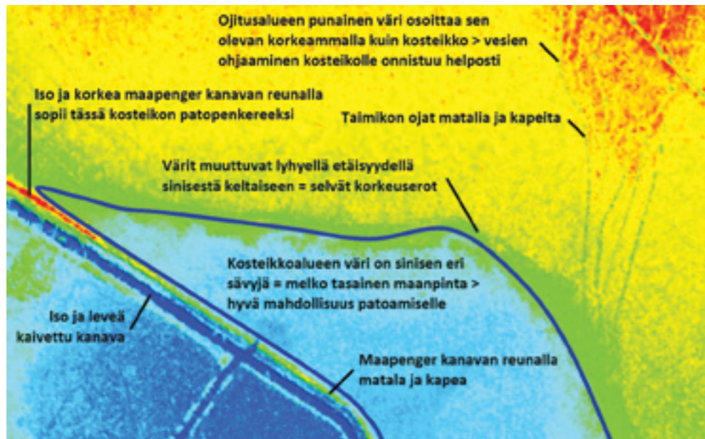
Laserkeilausaineisto antaa lisää tietoa esimerkiksi maanpintojen kaltevuusmuutoksista, tasaisuudesta ja muista erityisistä muodoista sekä ojien leveysistä ja syvyyksistä. © Maanmittauslaitos lupanumero 4496/MML/15.
