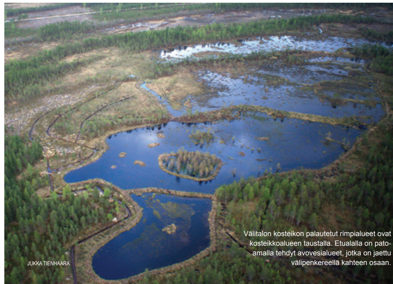
Vesialueiden palauttaminen rimpialueille voidaan tehdä matalien patopenkereiden avulla. Pintaturpeen laitto penkereen päälle vähentää puiden taimettumista ja siten helpottaa hoitoa.
